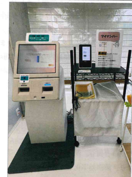
写真5 再来受付機とカードリーダー
